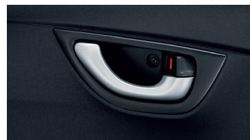
ระบบเซ็นทรัลล็อก พร้อมสวิตช์ควบคุมตำแหน่งคนขับ
