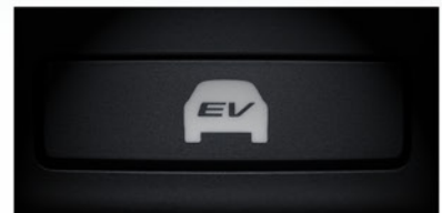
EV Mode สวิตช์ควบคุมโหมดการขับเคลื่อนด้วยมอเตอร์ไฟฟ้า เพื่อเข้าสู่โหมดการขับเคลื่อนที่ใช้กำลังจากมอเตอร์ไฟฟ้าในการขับเคลื่อน ให้การขับขี่ที่ประหยัดน้ำมันและเงียบสนิท
