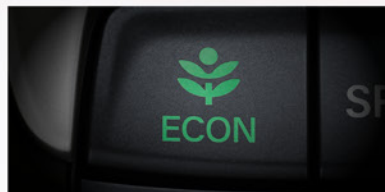
ECON Mode เป็นระบบที่ช่วยลดการใช้พลังงานที่สิ้นเปลือง โดยการปรับการทำงานของเครื่องยนต์และระบบเกียร์ให้สัมพันธ์กัน นอกจากนี้ ระบบจะปรับการทำงานของระบบปรับอากาศ และการหมุนเวียนอากาศภายในห้องโดยสารให้เหมาะสม ซึ่งจะช่วยให้เครื่องยนต์ใช้พลังงานอย่างมีประสิทธิภาพ
