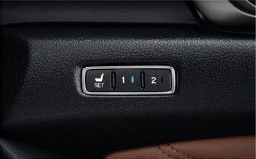
ระบบบันทึกตำแหน่งเบาะนั่งของผู้ขับขี่ พร้อมเลื่อนอัตโนมัติเวลาขึ้น-ลงรถ
