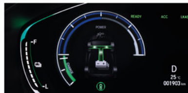
Power and Charge Mode หน้าจอแสดงผลการจ่ายไฟและชาร์จไฟของระบบไฮบริด
